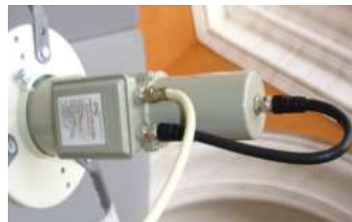
Detalhe LNB da antena
