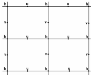
Figura 1 – Grade do tipo C de Arakawa. Variáveis termodinâmicas ( h ); componente zonal ( u ); componente meridional ( v ) do vento.
